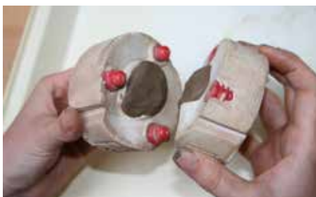
Obě poloviny formy se musí před lisováním správně spojit
